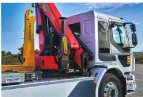
Le FE Electric 6x2, équipé d'un bras Palfinger PHT 18 coulissant et d'une grue Palfinger PK 18002-EH, est notamment dédié aux applications de type approche TP dans un environnement urbain.
